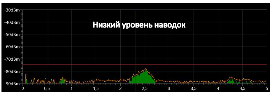
Розетки №2...5 – нет опасности, низкий уровень наводок
